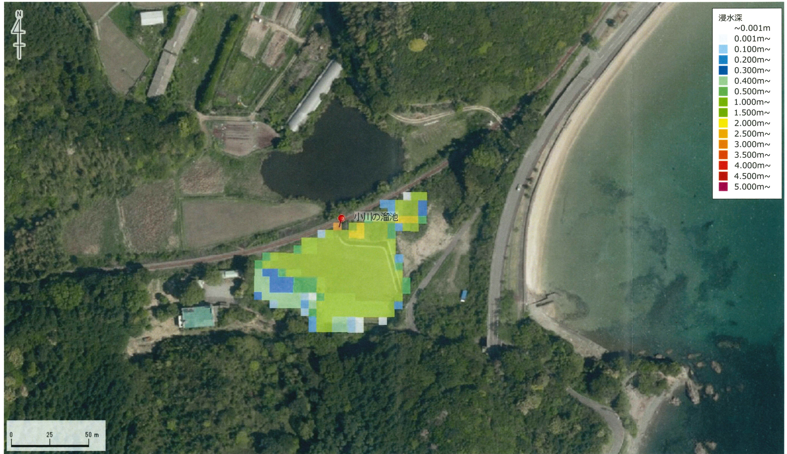
図 4-14 最大浸水深 (小川の溜池)
